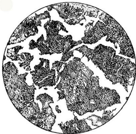
Рисунок 1 – Микроструктура стали 45 без упрочнения, x500
