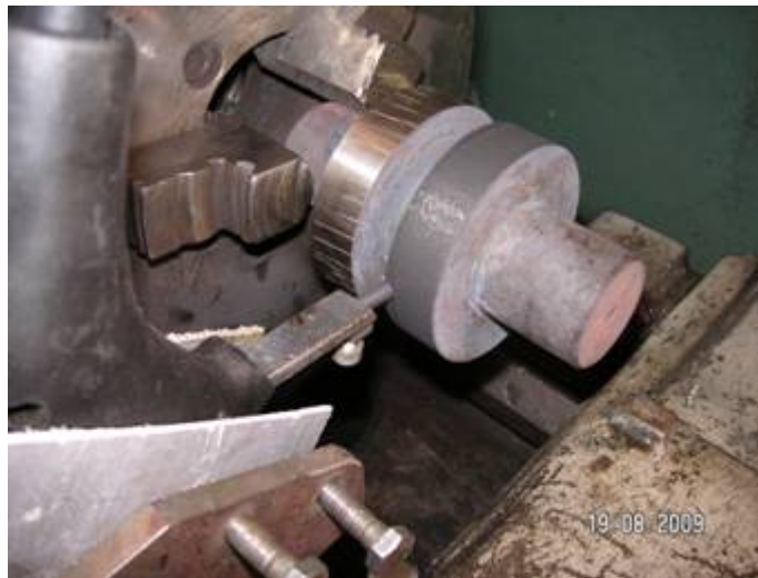
Рисунок 2 – ЦЭЭЛ с использованием токарного станка
