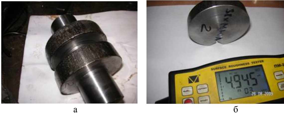
Рисунок 1 – Стальные образцы для исследования результатов ЦЭЭЛ
