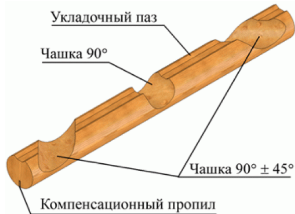
Рисунок 2. Основные элементы оцилиндрованного бревна.
