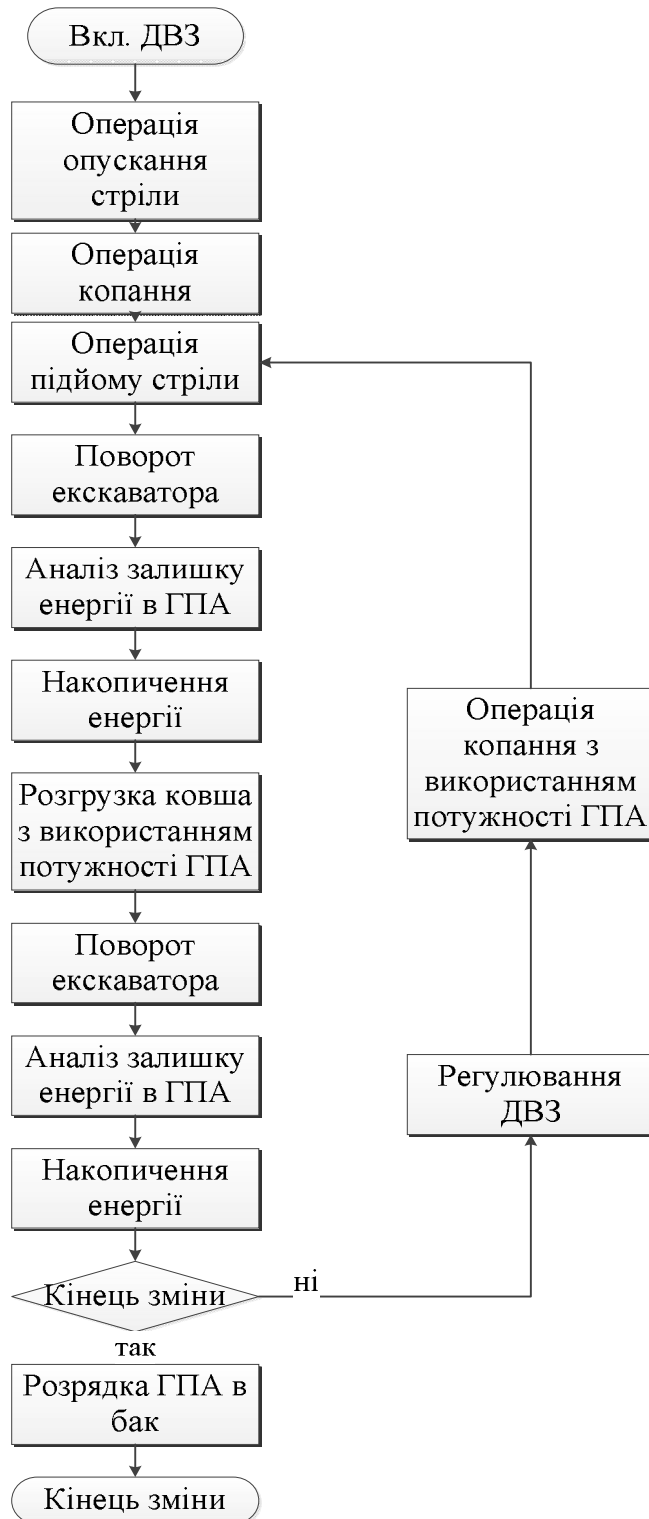
Рисунок 4. Алгоритм роботи екскаватора з системою акумулювання енергії
