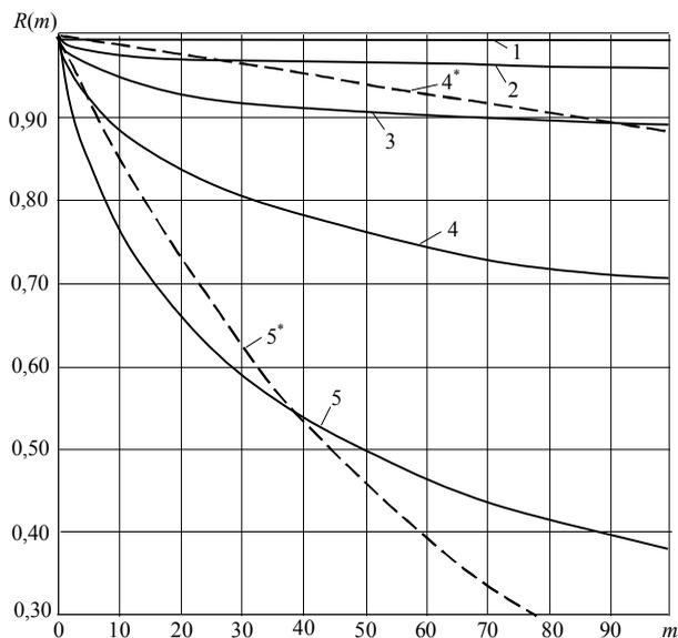
Рис.2. Графики прогнозируемой вероятности безотказной работы в зависимости от числа экстремальных нагружений при: 1 -  $V_n = 0$ ; 2 -  $V_n = 0,1$ ; 3 -  $V_n = 0,15$ ; 4 -  $V_n = 0,2$ ; 5 -  $V_n = 0,25$ ; 4\* -  $V_n = 0$ ;  $V_n = 0,2$ ; 5\* -  $V_n = 0$ ;  $V_n = 0,25$
