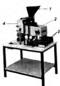
Рисунок 5 – Гратчастий сепаратор "Damas": 1 - бункер для насіння; 2 - система сит; 3 - збірки насіння; 4 - вібраційна система
