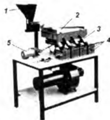
Рисунок 4 – Гравітаційний сепаратор: 1 - подаючий бункер; 2 - сортувальний стіл; 3 - лотки; 4 - ящики; 5 - приводний електромотор з ексцентриковою системою
