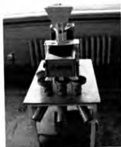
Рисунок 5 – Гратчастий сепаратор "Damas": 1 - бункер для насіння; 2 - система сит; 3 - збірки насіння; 4 - вібраційна система
