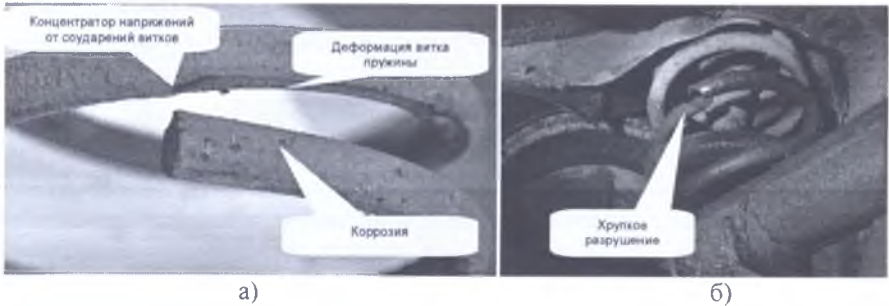
Рисунок 4 – Дефекты, выявленные при визуальном осмотре пружин подвески: а) – коррозия, вмятины; б) – хрупкое разрушение
