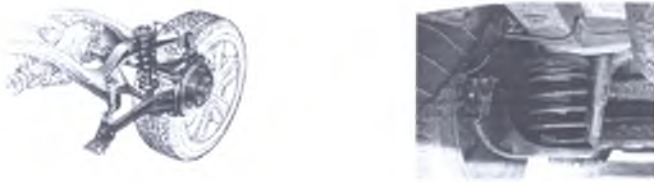
Рисунок 1 – Размещение пружин в конструкции подвески ходовой ТС
