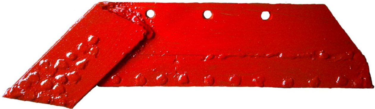
Рисунок 1 – Відновлений леміш, локально зміцнений електродом Т-590
