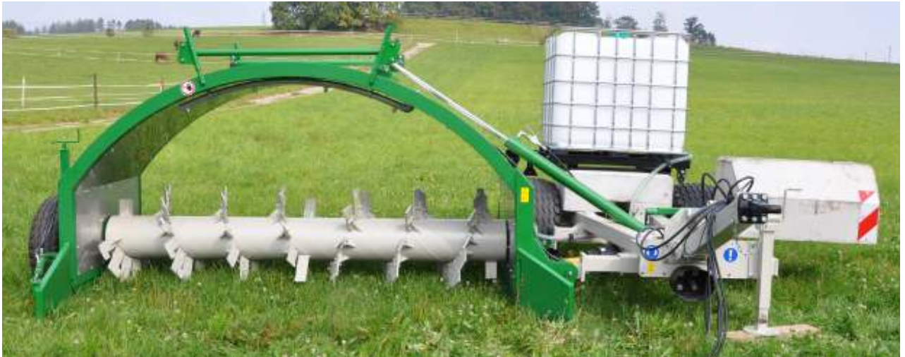
Рисунок 5 - Роторний аератор-змішувач TG 301 виробництва фірм Gujer
