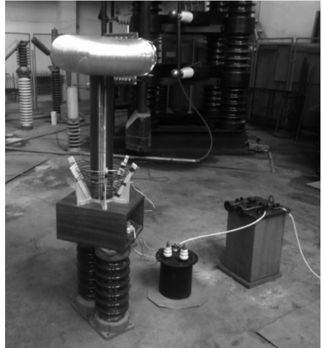
Рисунок 3 – Зовнішній вигляд експериментальної установки з ВРТ
