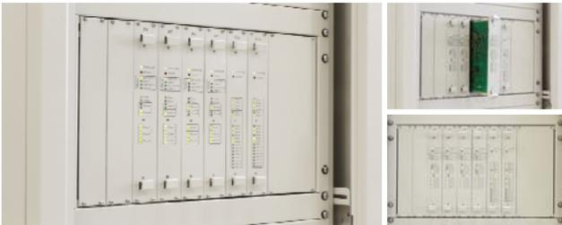
Рисунок 5 – Безопасный ПЛИС-контроллер параллельного действия S4C
