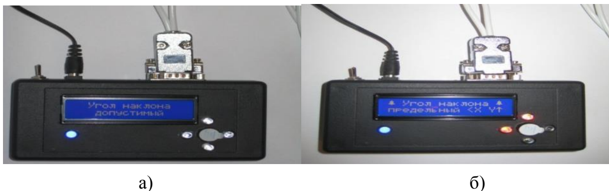
Рис . 3 – Общий вид прибора ПЗФ- 2К: а) « Угол наклона допустимый»; б) «Угол наклона предельный X или Y».
