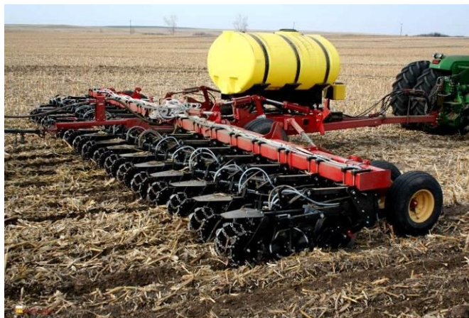
Рис. 2 – Передпосівна обробка ґрунту з одночасним внесенням добрив
