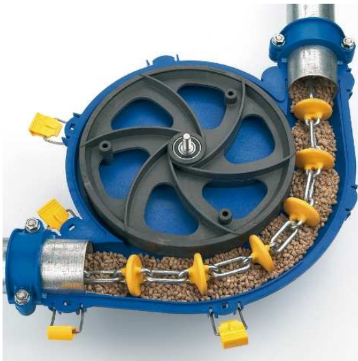
Рисунок 3 – Робочий орган шайбового конвеєра фірми “Limatex Agro”
