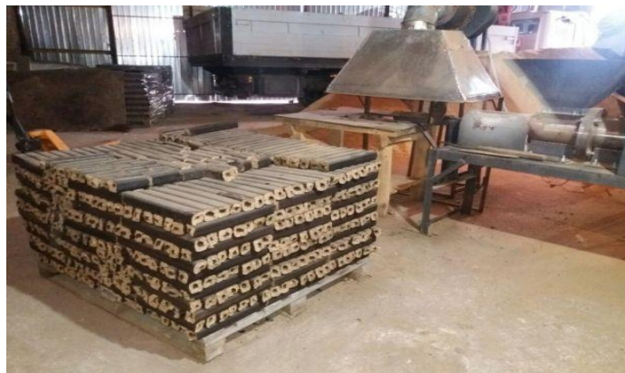
Рис. 3 – Паливні брикети виконані по технології Pini&Kaу
