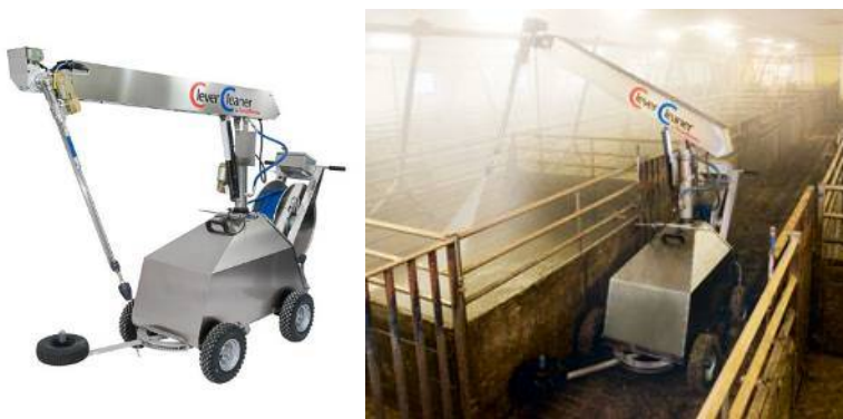
Рис. 3 Моющий робот Clever Cleaner фирмы «Ramsta Robotics» (слева) и процесс мойки (справа).
