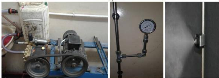
Рис. 1. Лабораторна установка для випробування форсунок систем туманоутворення: а – схема; б – загальний вигляд; 1 - акумуляційна ємність; 2 – плунжерний насос; 3 – пасова передача; 4 – електродвигун; 5 – манометр; 6 – труба високого тиску з фітингами; 7 – форсунка(еталон); 8 – форсунка( t=750 год); 9 – форсунка( t=1500 год); 10 – кульовий кран.
