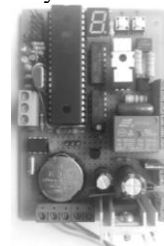
Рисунок 1 – Плата контролера симісторного фазоімпульсного регулятора обертів однофазного асинхронного електродвигуна
