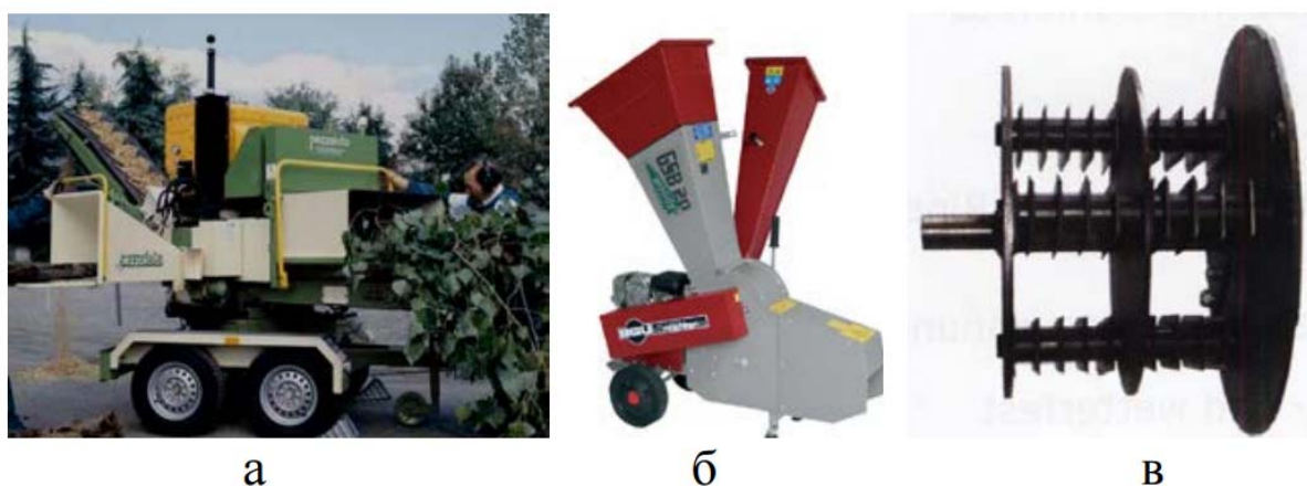
Рисунок 8 - Деревоподрібнювачі з комбінованим різальним пристроєм: а – деревоподрібнювач К 5500 (Pezzolato, Італія); б – деревоподрібнювач GSE 20 (BGU Maschinen, Німеччина); в – комбінований (дисково-молотковий) різальний пристрій
