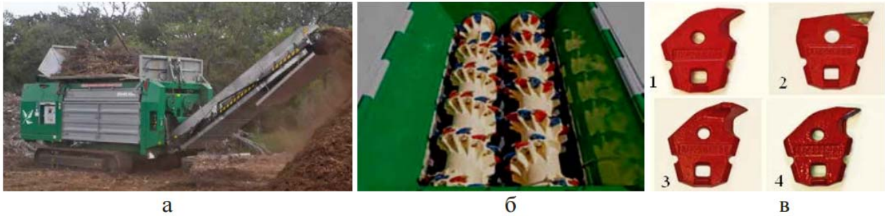
Рисунок 9 - Великогабаритна деревоподрібнювальна машина Crambo 5000: а – загальний вигляд; б – двобарабанний різальний пристрій; в – типи зубів 1 – серпоподібні зуби; 2 – гакоподібні зуби; 3 – стругальні зуби; 4 – серпоподібні зуби із змінними наконечниками
