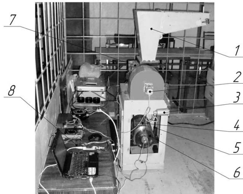
Рис. 1. Зовнішній вигляд експериментальної роторної дробарки: 1 – завантажувальний бункер; 2 – тахогенератор; 3 – тахометр; 4 – електродвигун; 5 – клинопасова передача; 6 – пружна муфта; 7 – ножова голівка; 8 – вимірювальна система
