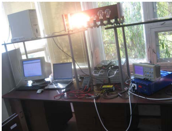
Рис. 4. Вузол зарядження-розрядження акумуляторних батарей
