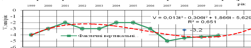
Рис. 1. Графік зміни річних вертикальних деформацій Rp8 профільної лінії «3» лежачого боку покладів ш. «Ювілейна» ПАТ «Сува Балка»*(штриховою лінією показано лінію тренду)
