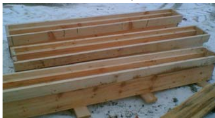
Рис. 1. Загальний вигляд опалубки та балок контрольної серії таврового перерізу
