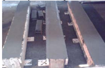
Рис. 1. Загальний вигляд опалубки та балок контрольної серії таврового перерізу
