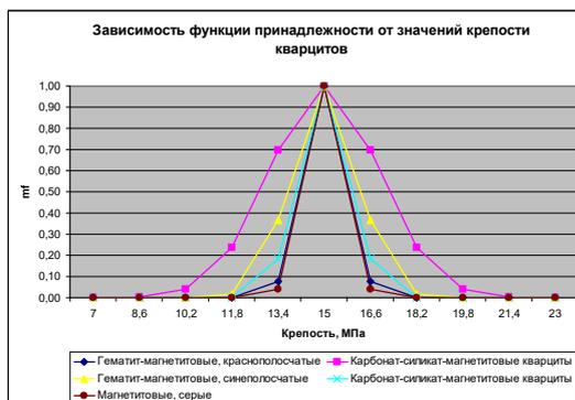
Рис. 3. График зависимости функции принадлежности  $\mu_f$  от крепости  $f$  гауссова типа для различных типов руды
