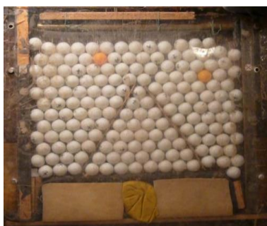
Рис. 2. Общий вид модели с искусственными плоскостями скольжения (дискретный материал-пустотелые пластиковые шары)
