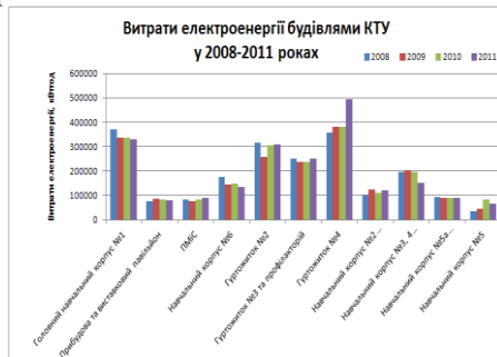
Рис. 2. Витрати електроенергії будівлями КНУ у 2008-2011 роках, кВт·год/м 2
