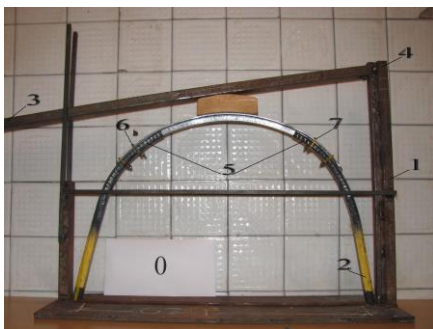
Рис. 2. Стенд для испытаний работоспособности арочной крепи: 1 - пространственная рама; 2 - модель трехзвенной крепи; 3 - нагрузочный рычаг; 4 - место крепления рычага к пространственной раме; 5 - калиброванная шкала в местах соединения несущих элементов крепи; 6 - замок (узел) №1; 7 - замок (узел) №2
