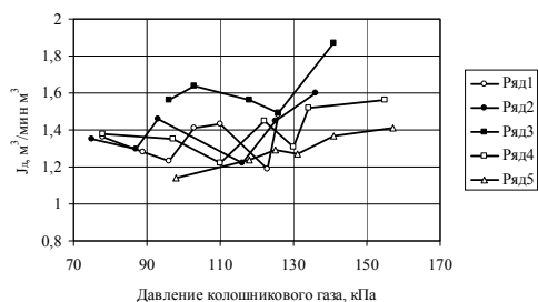
Рис. 2. Зависимость интенсивности плавки по дутью J_d от давления колошниково-го газа: 1 - ДП №1, 2 - ДП №5, 3 - ДП №7, 4 - ДП №8, 5 - ДП №9
