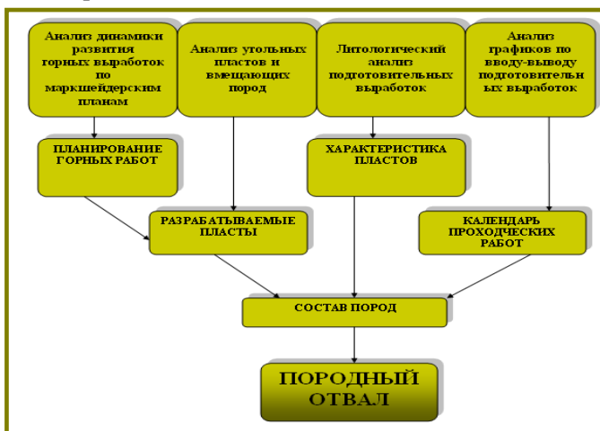
Рис.2. - Схема литологического состава породного отвала
