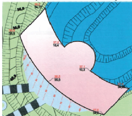
Рис. 4. Посадка будівлі на рельєф
