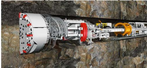
**Рис. 1.** Тоннелепроходческий комплекс фирмы «Herrenknecht» [3]
