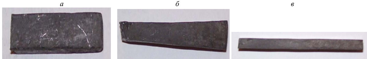
Рис. 5. Результати прокатки зразків по розробаній технології: а – початковий зразок; б – раскат после прокатки в прямом направлении; в – раскат после прокатки в обратном направлении
