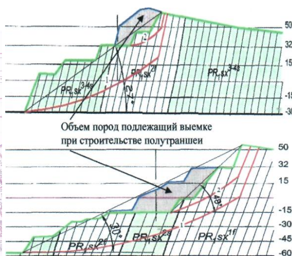
Рис. 3. Схемы к расчету устойчивости групп уступов по разрезу 2-2 (а) и разрезу 4-4 (б)
