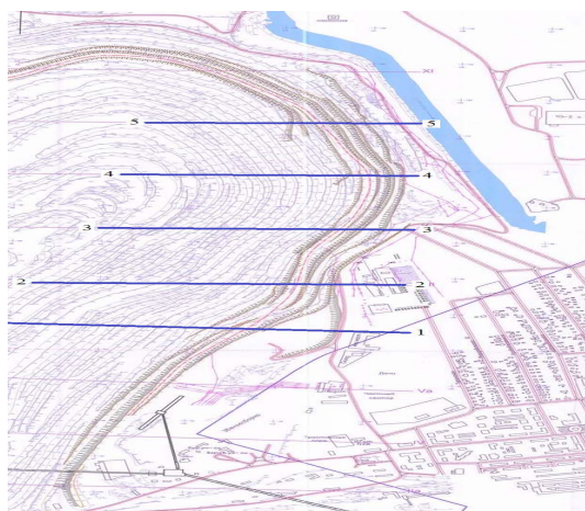
Рис. 2. Положение расчетных разрезов на плане восточного борта карьера ОАО «ЮГОК»
