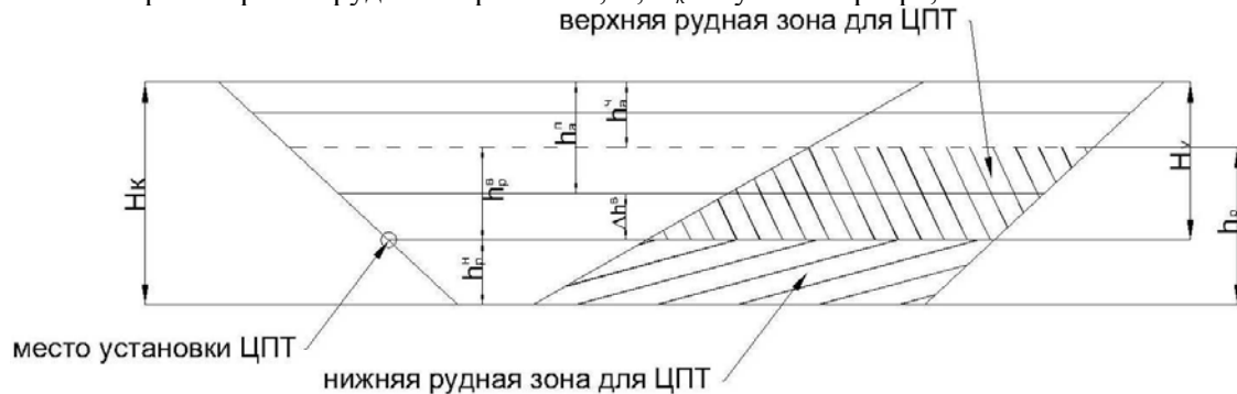
Рис. 2 Схема для расчета глубины расположения горизонта разгрузки ЦПТ
