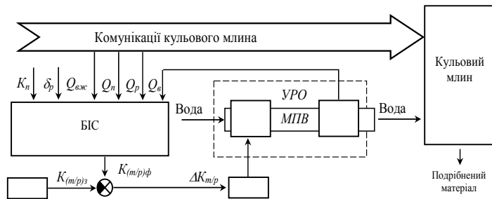
Рис. 1. Функціональна схема стохастичної системи автоматичного керування співвідношенням тверде/рідке у кульовому млині
