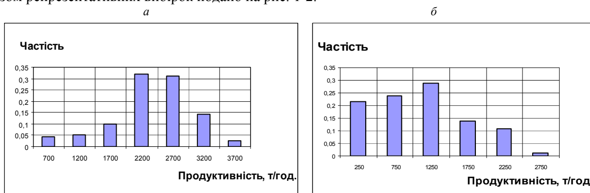
Рис. 1. Гістограма розподілу навантажень Першотравневого кар'єру: а - по руді; б - по скельній породі
