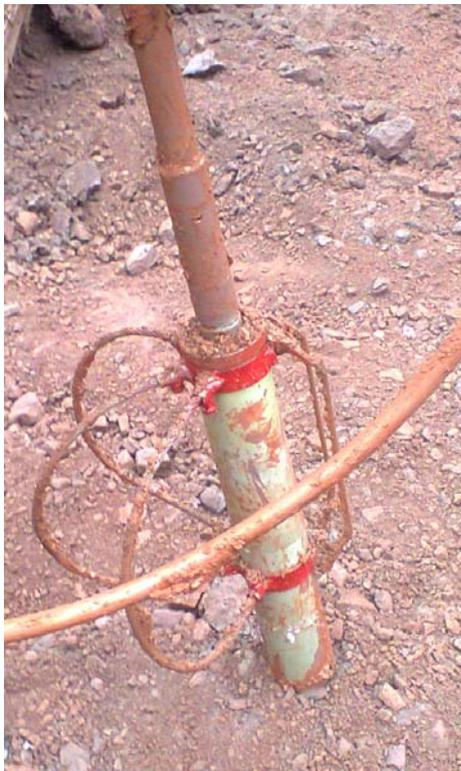
Рис. 2. Внешний вид макета зондового устройства
