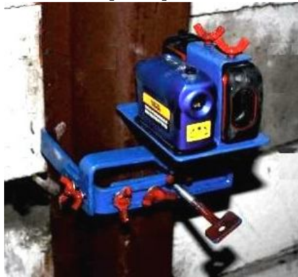
Рис. 6. Установка пристрою на стійці металевого кріплення
