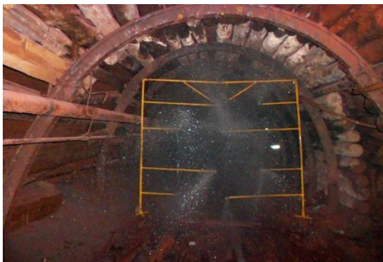
Рис. 2. Гідравлічна завіса «Дош» під час очищення повітря в гірничій виробці в шахті «Тернівська»
