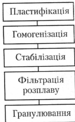
Рис. 3. Загальна технологічна схема гранулювання
