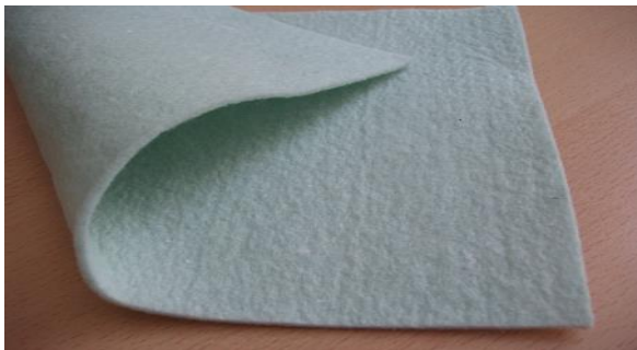
Рис. 1. Типи геотекстильних матеріалів: а – тканий; б – нетканый
