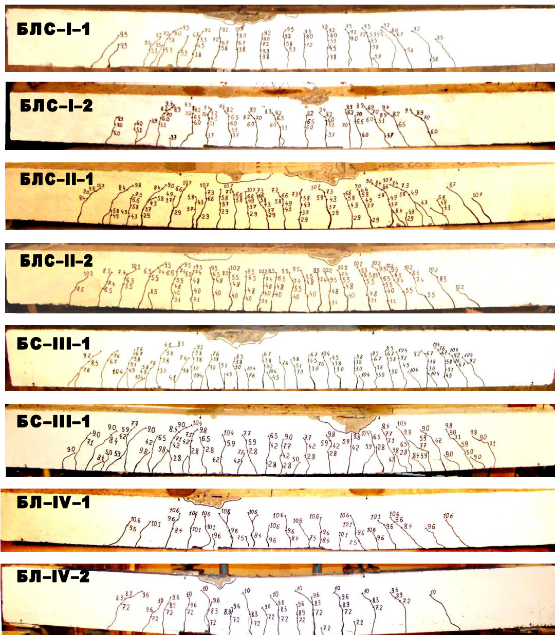
Рис. 3. Характер руйнування дослідних балок.
