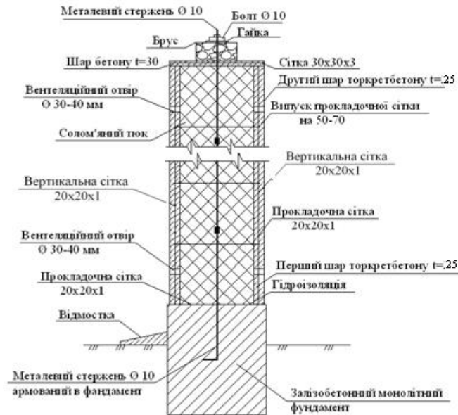
Рис. 3. Конструкція стіни.
