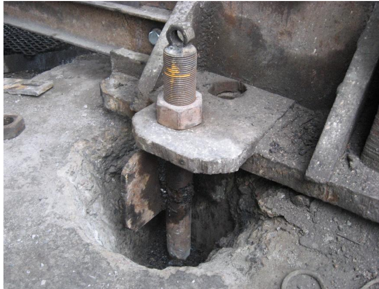
Рис. 8. Розрив анкера приводу.
