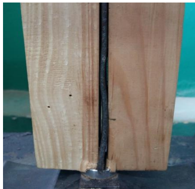
Рис. 3. Характер руйнування металодерев'яного елемента від зминання та втрати стійкості металевої пластини
