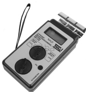
Rys. 3. Wilgotnościomierz do pomiaru wilgotności podłoża betonowego
