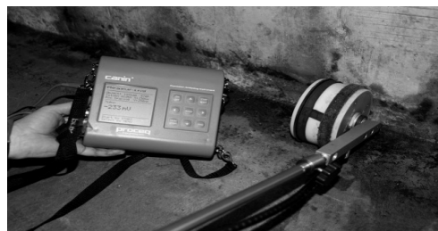
Rys. 6. Urządzenie do określania prawdopodobieństwa wystąpienia korozji zbrojenia w konstrukcjach żelbetowych
