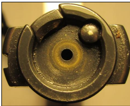
Рис. 1. Чашка затвора карабіна «Howa 1500 Hogue Score».
