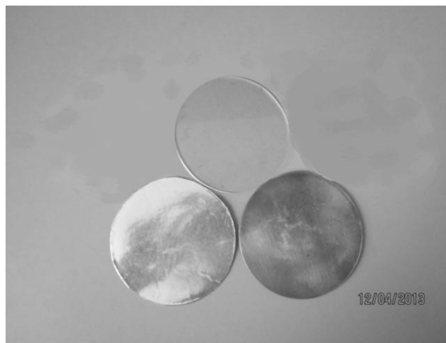
Рис 1. Зразки матеріалів для визначення коефіцієнта тертя: 1 – нержавіюча сталь, 2 – скло, 3 – металева фольга.
