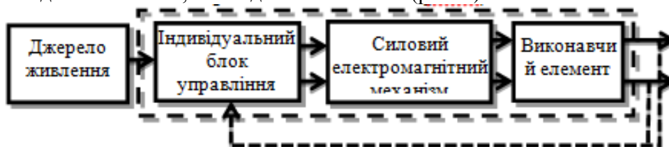
Рис. 3. Схема індивідуального управління пульсаторами доїльного апарата.
