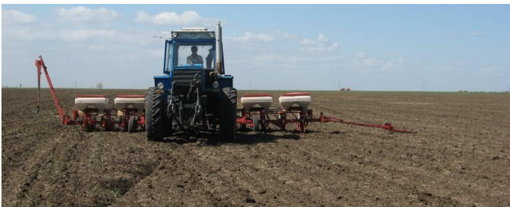
Рис. 3. Асиметричний посівний агрегат у складі трактора ХТЗ-16131 та 12-рядної просапної сівалки «Optima».
